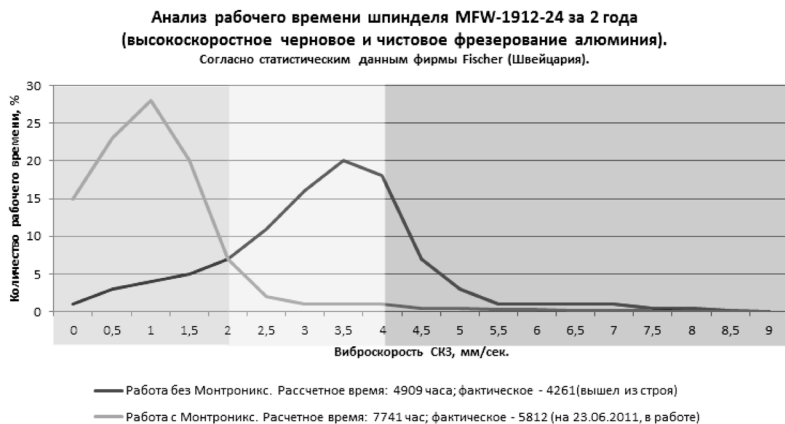
Рисунок 2. Анализ рабочего времени шпинделя за 2 года эксплуатации (высокоскоростное черновое и чистовое фрезерование алюминия). Ориентировочная стоимость ремонта такого типа шпинделя – 17000$ (замена подшипников, уплотнений, ротационных соединений).
